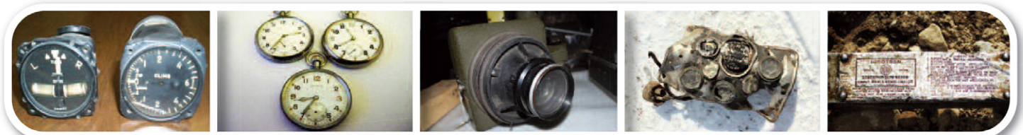
Cadrans contenant un composé lumineux au radium
